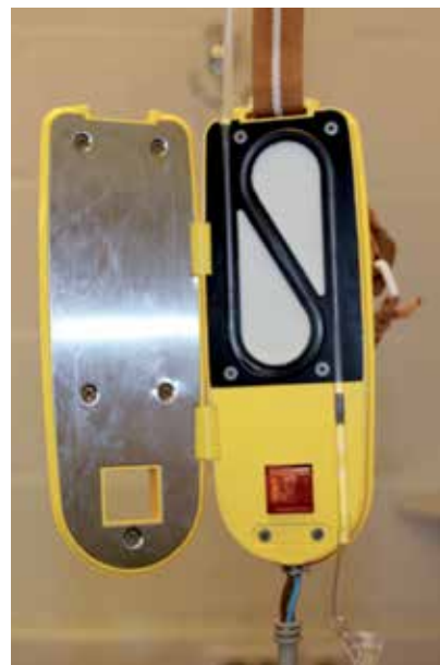
Figure 2 : Système permettant de chauffer la tubulure des perfusions intraveineuses.
